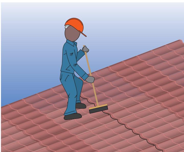
Les résidus et les copeaux métalliques dus au sciage ou aux perçages doivent être éliminés immédiatement à sec à l'aide d'une brosse douce. Si un lavage est à envisager, des produits de nettoyage normaux (sans solvant - pH neutre) sont à utiliser.
