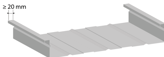
▲ Figure 19. Exemple de plateau de bardage. Retour de largeur minimum 20 mm
